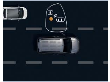
Sistem za opozarjanje na mrtvi kot (Blind Spot)
