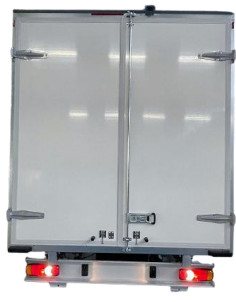
Nadgradnja Cargo Box z zadnjimi vrati (odpiranje 270°)
