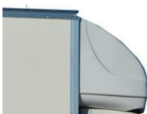
Strešni kovček (spojler) za lahko nadgradnjo Cargo Box, odlagalni prostor nad voznikovo kabino dostopno iz tovarnega prostora
