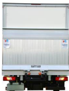
Nadgradnja Cargo Box z zgornjimi dviznimi vrati in nakladalno ploščadjo (rampo)
