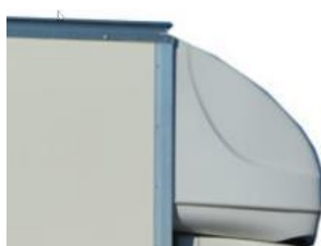
Strešni kovček (spoiler) za lahko nadgradnjo Cargo Box, odlagalni prostor nad voznikovo kabino dostopen iz tovarnega prostora
